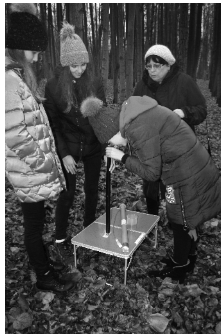
Определение мутности и прозрачности воды из Девкиного ручья.
